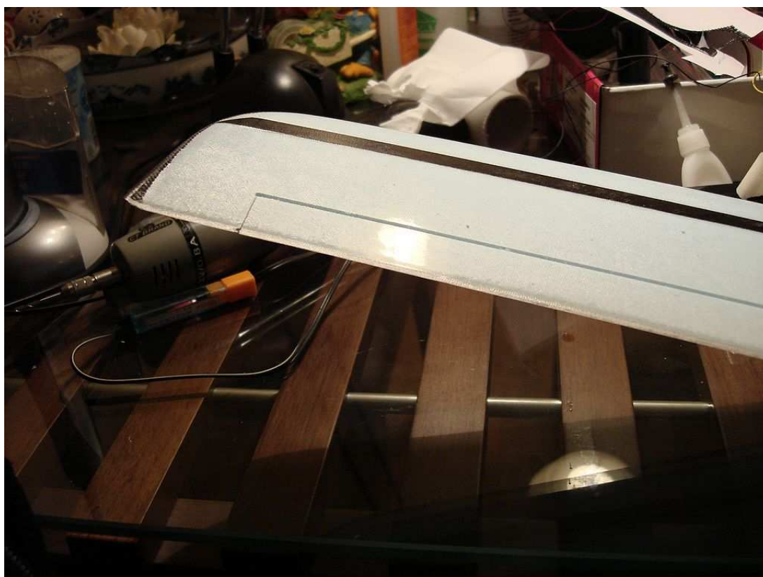
Slepení křídla (5 min. epoxy)
