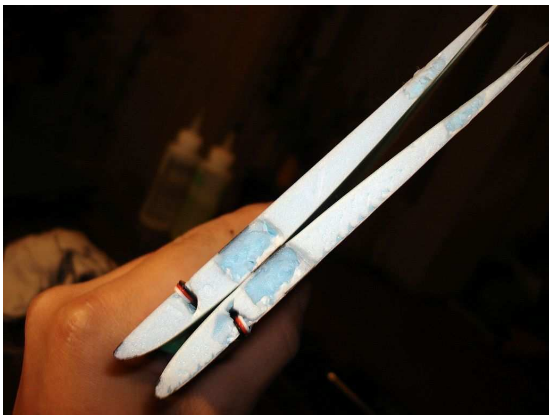
Vydlabeme polystyren v okolí otvorů pro upevňovací šrouby.
