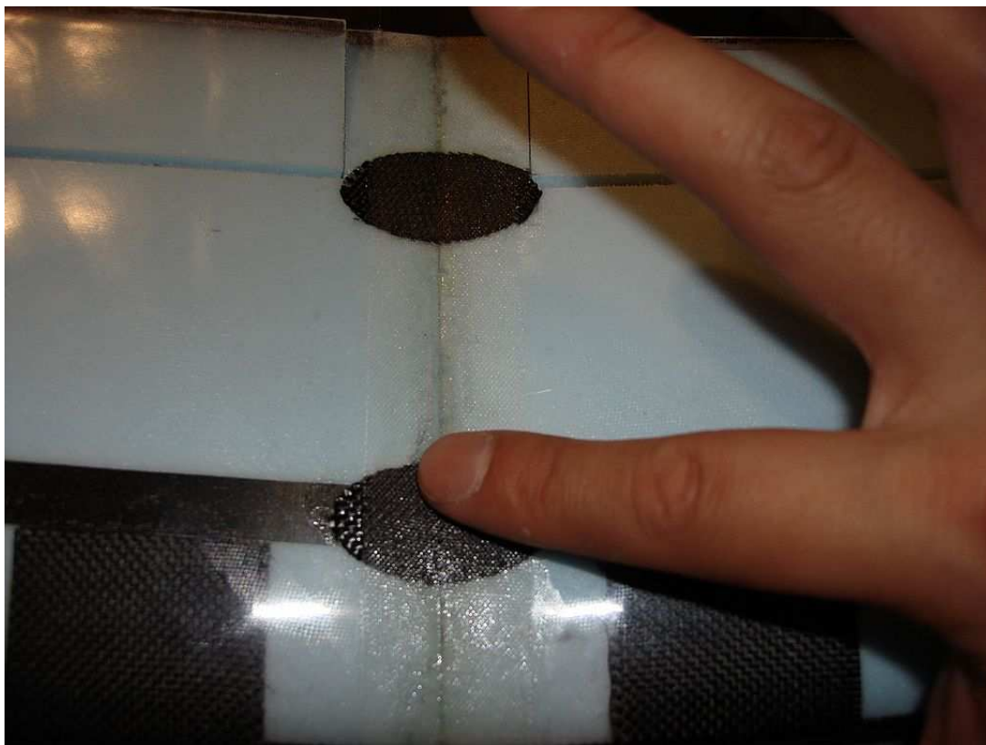
Přiložíme na spáru
