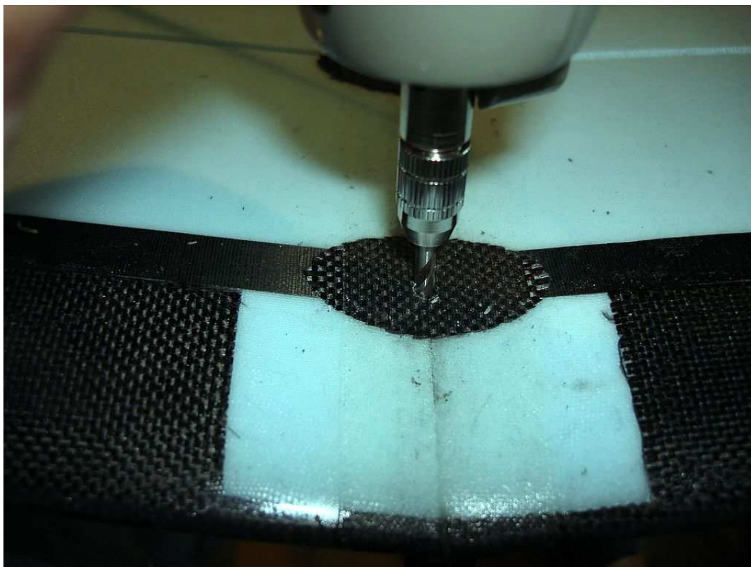
Vyvrátáme otvory pro upevňovací šrouby křídla
