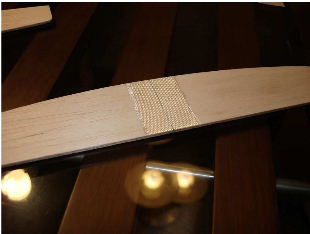
Připravíme směrovku a výškovku. Podle střední čáry přiložíme sklotextilové zesílení – stejně pro směrovku a výškovku.
