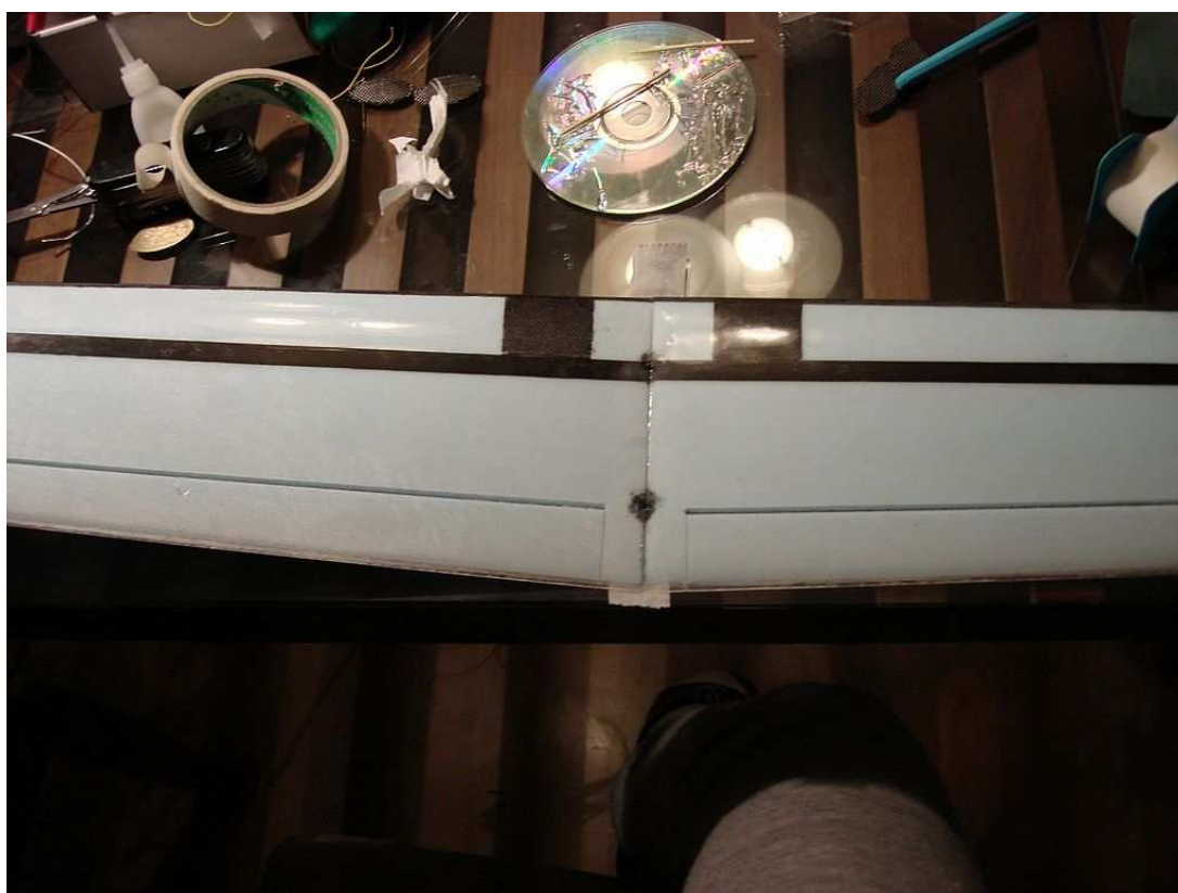
Slepení křídla (5 min. epoxy)
